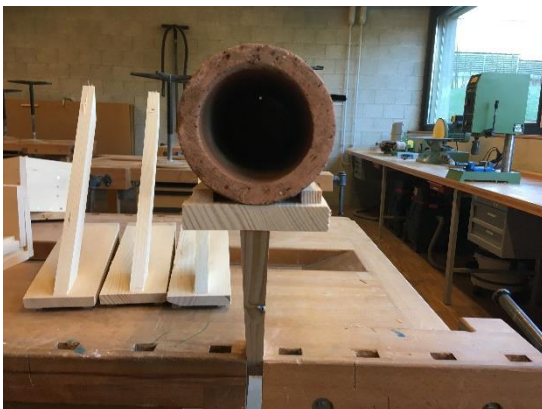
Montagehilfe für Tonröhren aus Schirmbrettern und Dachlatten.
